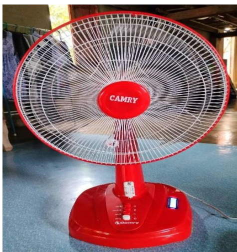
รูปที่ 4.1 พัดลมปรับระดับอัตโนมัติตามอุณหภูมิ
