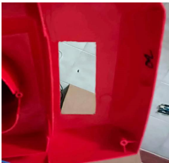
รูปที่ ก.2 เจาะรูเพื่อใส่จอ LCD
